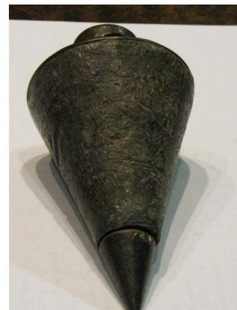
Bem. WR: Ein sehr interessantes Stück. Es scheint aus einem gewöhnlichen Amerikanischen Eisenlot zu bestehen, das auf einer Drehmaschine nachträglich bearbeitet wurde. Dann wurde der ausgedrehte Teil in einer Form mit Blei ausgegossen. Der Spalt entsteht, wenn das heiße Blei sich abkühlt und sich zusammen zieht. Ansatzstellen von verschiedenen metallischen Materialien sind immer problematisch.
