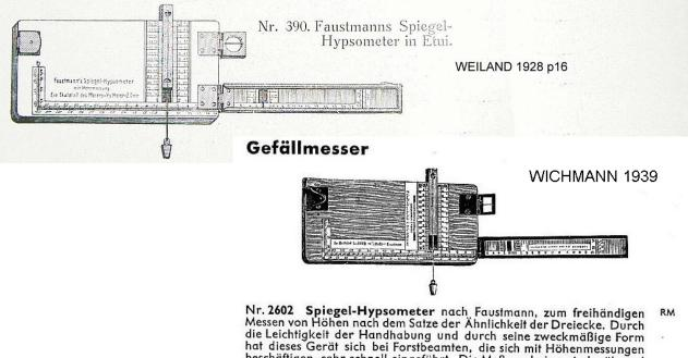
hat dieses Gerät sich bei Forstbeamten, die sich mit Höhenmessungen beschäftigen, sehr schnell eingeführt. Die Meßergebnisse sind während des Visierens durch ein Diopter auf der im Spiegel mit dem Senkel gleichzeitig sichtbaren Skala direkt abzulesen. Die Skala hat doppelte Bezeichnung, die eine für Metermaß, die andere für Strichmaß; in Behälter 14,—
