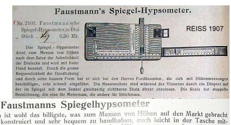
Dieses' Instrumentchen ist wohl das billigste, was zum Messen von Höhen auf den Markt gebracht wird. Es ist sehr einfach konstruiert und sehr bequem zu handhaben, auch leicht in der Tasche mitzuführen. Es wird mit freier Hand benutzt; die Ergebnisse der Höhenmessung werden während des Blickes durch das Diopter auf der Skala abgelesen, welche im Spiegel gleichzeitig mit dem Senkel sichtbar ist. Das Spiegelhypsometer ist in den Kreisen der Herren Forstleiche sehr verbreitet und beliebt.
