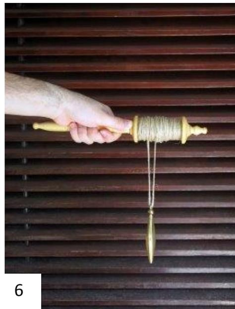
Doppelschnur und einem anatolischem Lot. (6, 7) Er bemerkte, dass der Vorteil der Doppelschnur ist, **dass das Lot ganz ruhig hängt**, im Gegensatz zu der einzelnen Schnur, bei der das Lot **sich unkontrolliert drehte**.
