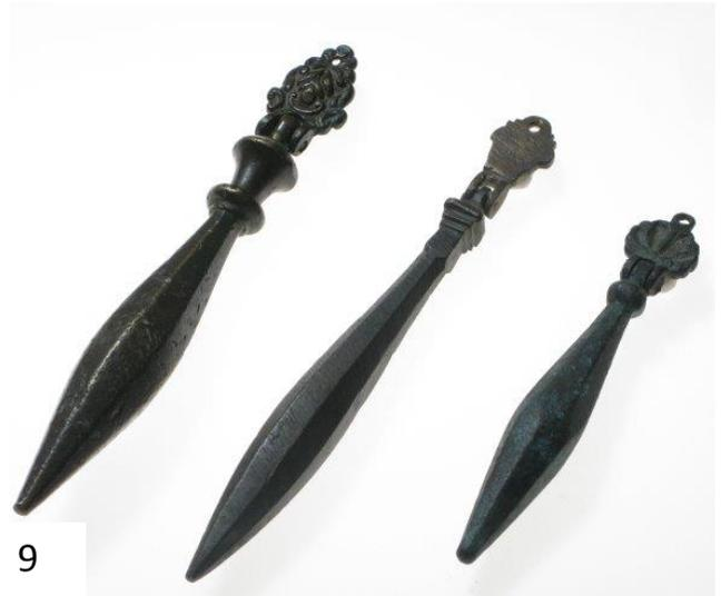
Nach und nach, möglicherweise aufgrund des westlichen Einflusses, **wurden die polygonalen Körper der anatolischen Lote durch kreisförmige (runde) ersetzt** und die eher umständliche Doppelschnur-Methode wurde für die einfachere Methode einer einzelnen Schnur aufgegeben.
